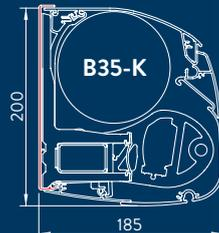
Différentes versions du B-35, du système ouvert (type A) au coffre entièrement fermé (type K). Le B-35 Prestige est uniquement disponible avec coffre fermé (type K) ou semi-fermé (type I). Le profil gouttière type G est disponible en option pour toutes les versions.
