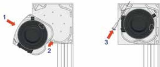
Dans les screens standards et ZIP, il est facile de retirer le tube d'enroulement sans démonter le screen, ce qui permet un montage simple.
