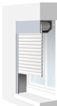
Sous linteau, enroulement intérieur
