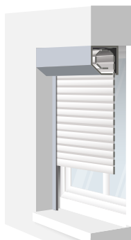
Sous linteau, enroulement extérieur
