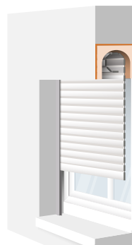
Avec coffre tunnel intégré dans la maçonnerie
